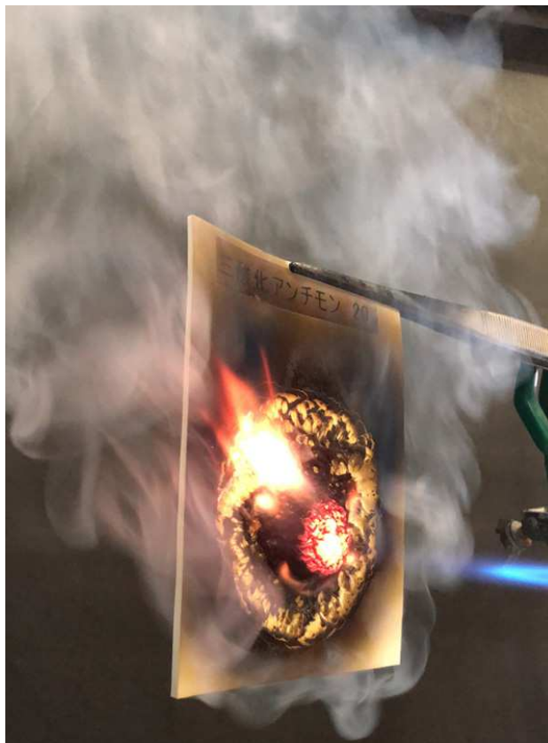
軟質 PVC シート 三酸化アンチモン 20 部添加品
